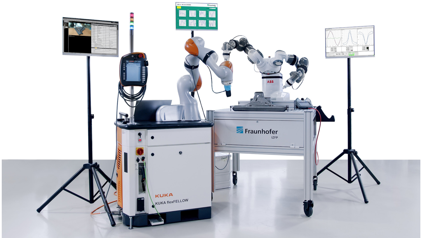
NDE4.0-Demonstrator: Mittels OPC UA koordinierte Prüfaufgabe an einem industriellen Bauteil mit drei Sensortypen (Wirbelstrom, Ultraschall und 3MA II) sowie gemeinsame Ergebnisdarstellung und Dokumentation im DICONDE-Format ( https://www.youtube.com/watch?v=74Kn4LDwkE0&t=1s )
