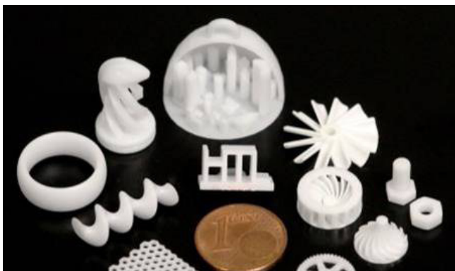
Filigrane Bauteile aus Keramik, die mittels stereolithographischem 3D-Druck hergestellt wurden. Foto: HTL
