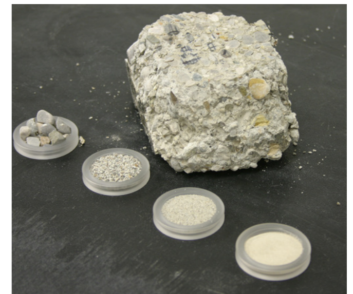
Vorher, nachher: Die Betonprobe, feinsäuberlich in ihre Bestandteile aufgetrennt. Die erhaltenen Kornfraktionen werden nach der elektrodynamischen Fragmentierung getrocknet und gesiebt. © Fraunhofer IBP
