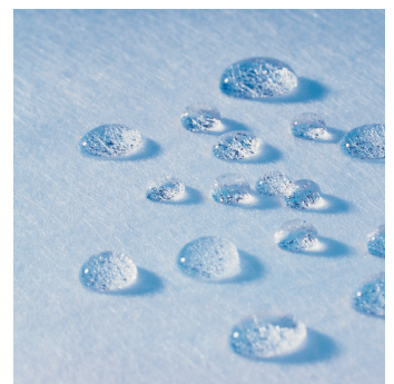
Baustoff mit neuen Eigenschaften: Hydrophobierte Gipsfaserplatten für Außenanwendungen.
